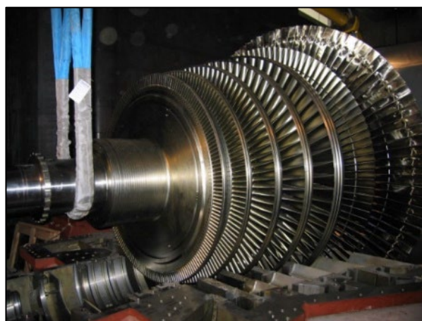
Figure 8 : Rotor du Groupe Turbo Alternateur (GTA)
